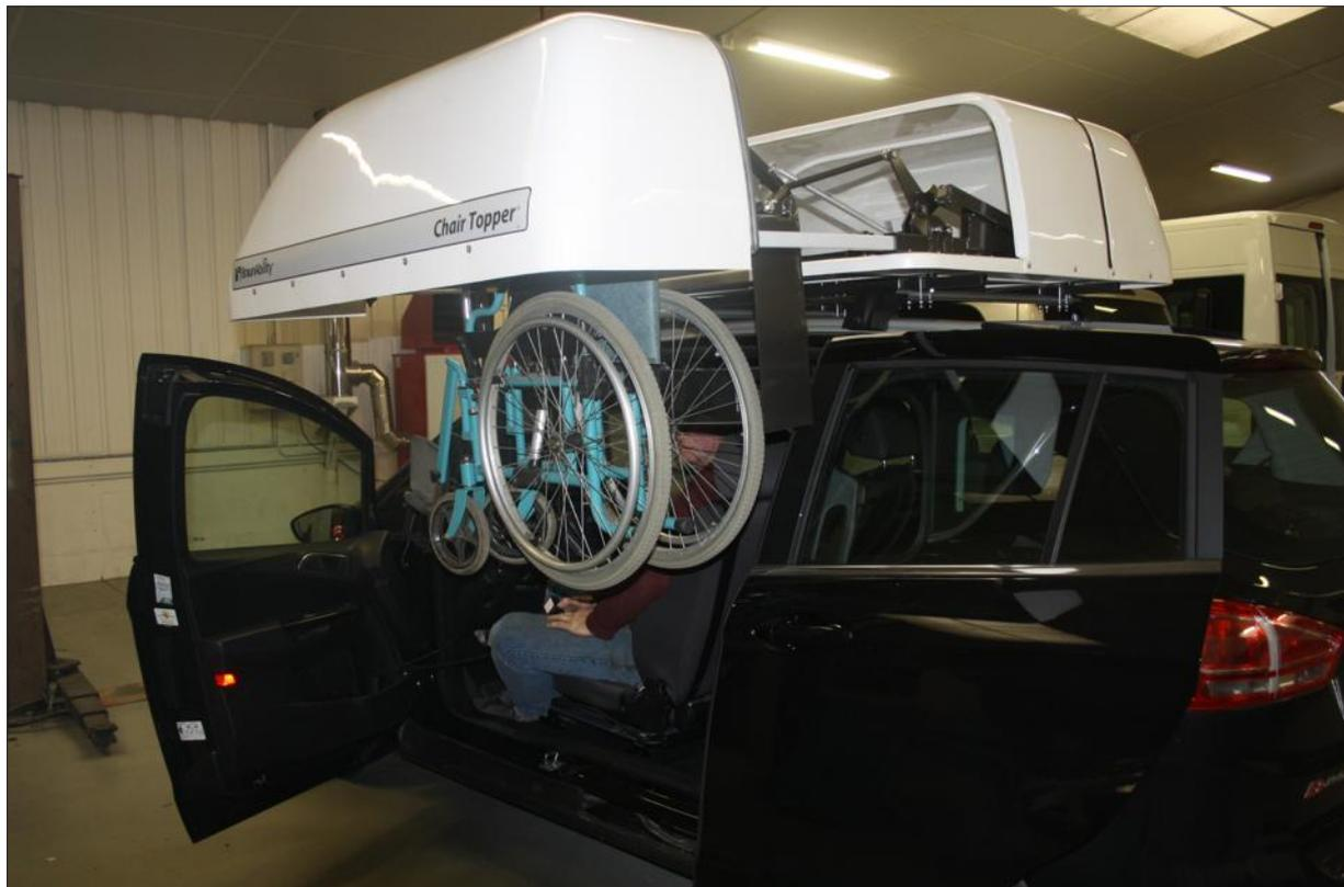
■ Depuis le siège conducteur, Jean-Paul Dunand actionne le mécanisme chargeant le fauteuil dans le coffre de toit. Photo Gérard COULON
